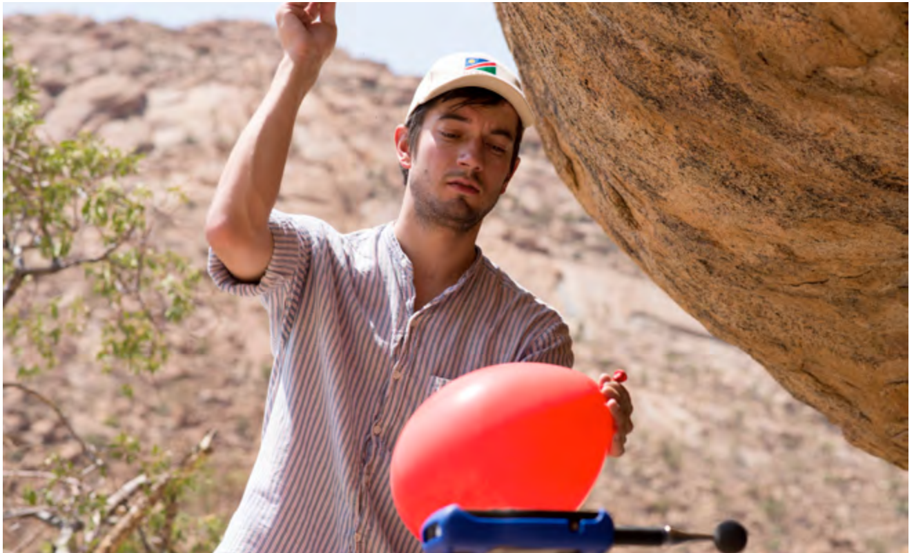
Dispositivo de medición móvil: grabación de la respuesta a la explosión de un globo de aire en una ubicación de pinturas rupestres con ayuda de un audiómetro. (Fotografía: Christian Kassung).
