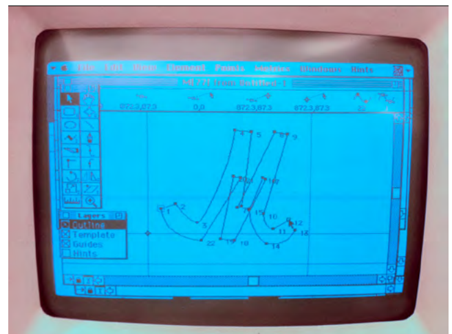
Digitale Konstruktion von Buchstaben aus Vektoren mit Anker- und Kurvenpunkten. Foto: Dan Reynolds | BWG 2015
