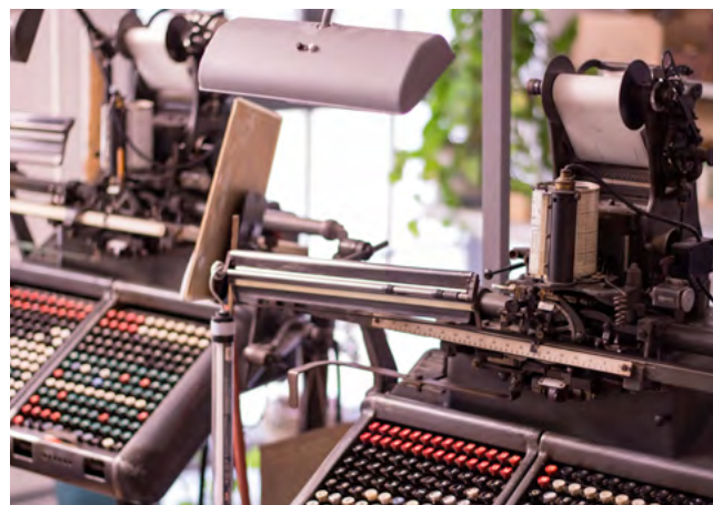
Taster für die Lochstreifenherstellung an der Monotype-Setzmaschine, Aufnahme in der Offizin Haag-Drugulin Graphischer Betrieb GmbH in Dresden. Foto: Christian Kassung | BWG 2016
