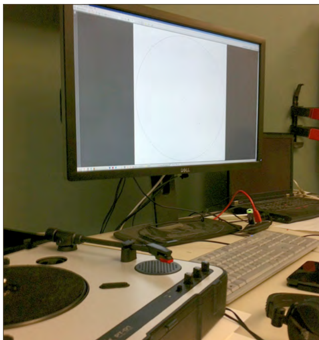
Auf dem Bildschirm ist eine Druckdatei mit der Schneidgrafik angezeigt. Diese Linien (Außenform und Mittelloch) werden vom Lasercutter geschnitten, bevor die Plattenrillen mit dem Klang gelasert wurden. (Foto: Daniel Paschen | BWG 2014)
