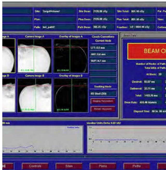
Fig. 3: Captura de pantalla del software de control de CyberKnife. La columna izquierda muestra la reconstrucción digital de las imágenes de rayos X (DRR) calculadas a partir de tomas por TC. En la columna central se puede ver las tomas de rayos X realizadas durante la operación, que son superpuestas con las DRR para verificar la localización del tumor de un modo visual. Fuente: <http://en.wikipedia.org/wiki/File:6DSkull.jpg>, © 2007 Wikipedia User Steven3045 (último acceso: 20/02/2014, 11:00)
