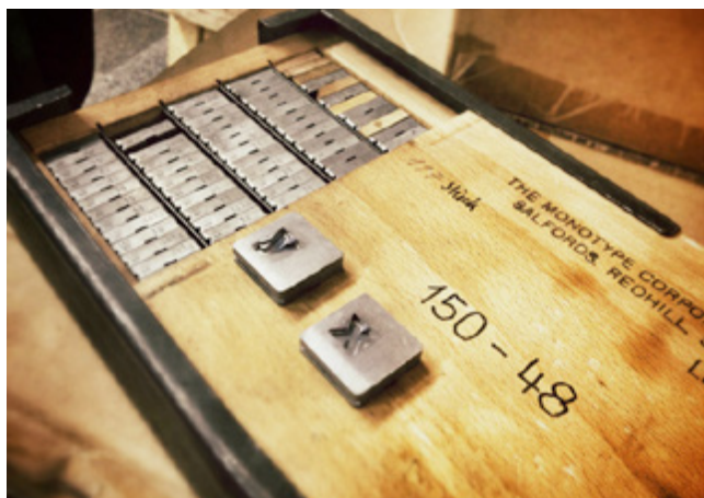
Plantillas de cono grande de la máquina Monotype, imagen tomada del archivo de tipos de letra de la imprenta Offizin Haag-Drugulin Graphischer Betrieb GmbH de Dresden. Fotografía: Christian Kassung | ICG 2016
