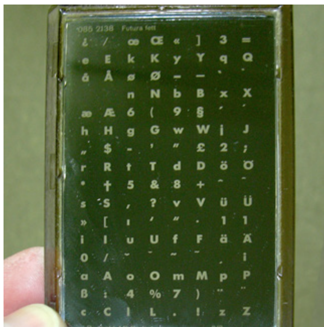
Placa de escritura Bertold-Diatronic para la fotocomposición
