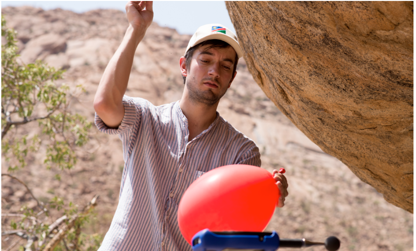
Mobile Messeinrichtung: Aufzeichnung der Impulsantwort eines zerplatzenden Luftballons an Felszeichnungsstätten mithilfe eines Audiometers. (Foto: Christian Kassung).
